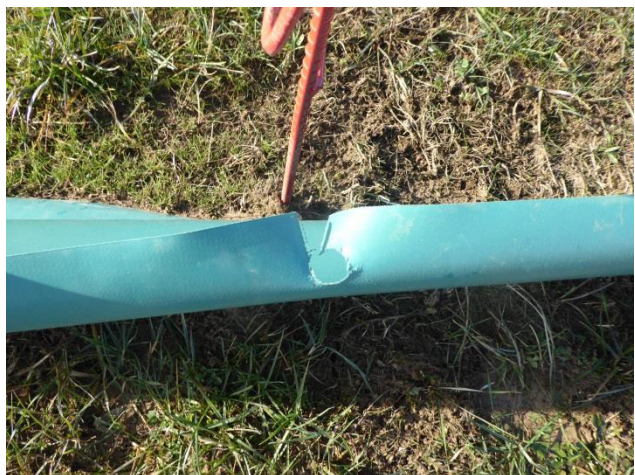
Abbildung 6: Aufgrund ausgerissener Ösen durchhängender Zaun.
