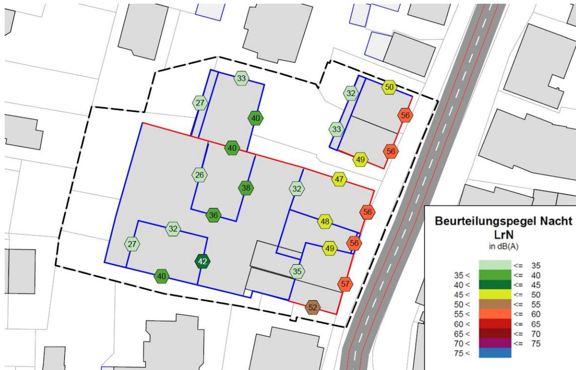
Abb. 2: Gebäudelärmkarte, Angezeigtes Stockwerk: Höchster Pegel Beurteilungspegel Nacht (Schallimmissionsprognose, Kurz und Fisher, 04. September 2020)
